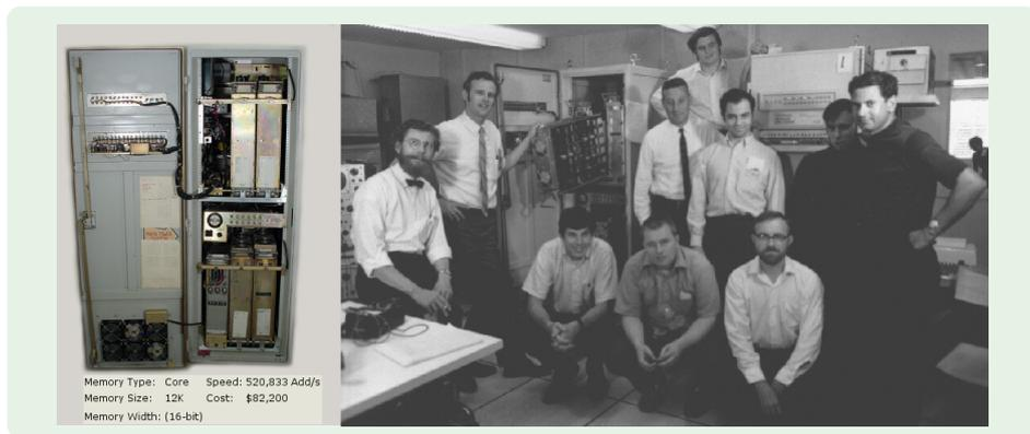
Der IMP war der erste Paketrouter. Er basierte auf einem Honeywell DPD-516 Rechner. US Senator Edward Kennedy gratulierte BBN in einem Telegramm zum Bau des *“Interfaith” Message Processor*, und dankte für die *“ecumenical” efforts*.
